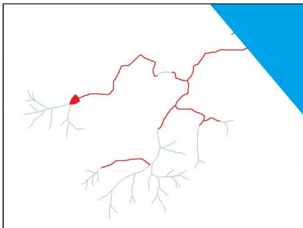
Figura 6. Esquema del escenario de restauración total . Se recupera el eje del río de Monelos y tres de sus tributarios (rego de Moitas, río Lagar y río de A Pastoriza), creando nuevos cauces en superficie. También se reformará el embalse de Meicende, creando una conexión con el nuevo cauce (en rojo).
