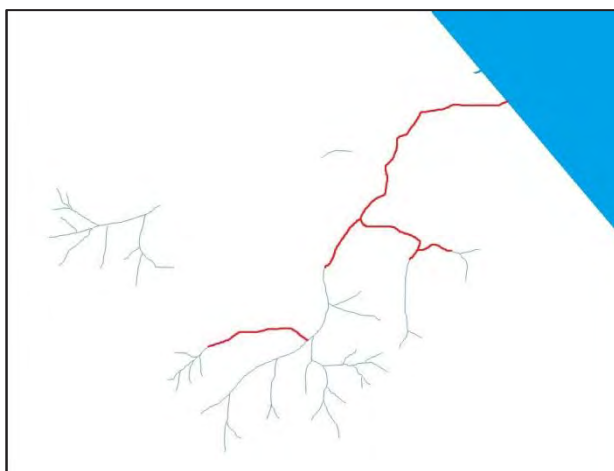
Figura 5. Esquema del escenario de restauración parcial . Se prioriza recuperar el eje del río de Monelos y dos de sus tributarios (rego de Moitas y río Lagar), creando nuevos cauces en superficie (en rojo).
